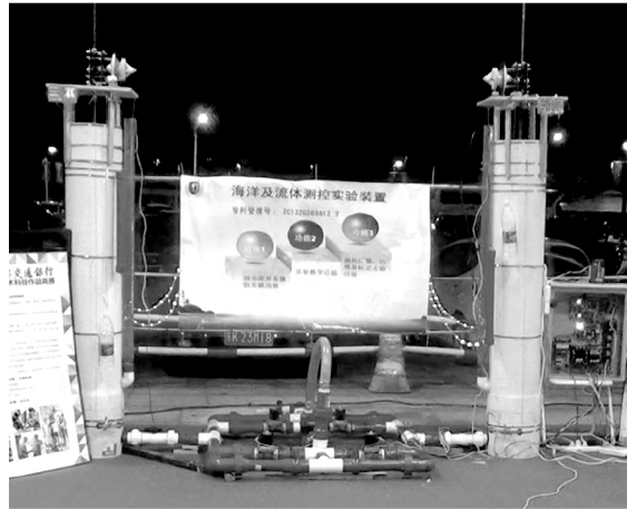
图 16 波浪能振荡浮子转换方式实验装置运行状况
