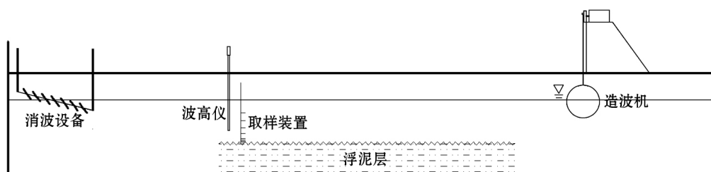
图 1 实验水槽的纵剖面图
