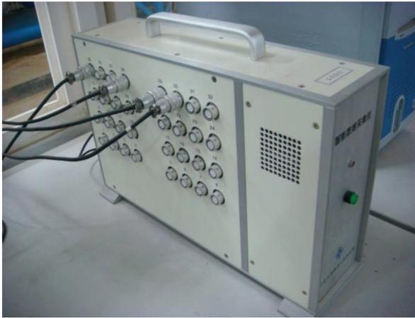
图 5 SG2000 型智能数据采集仪
