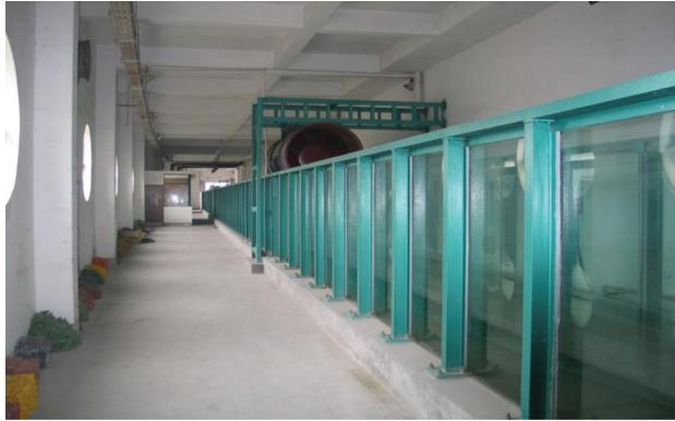
图 1 试验水槽( $70\text{ m} \times 1.2\text{ m} \times 1.7\text{ m}$ )Fig.1 Experimental flume ( $70\text{ m} \times 1.2\text{ m} \times 1.7\text{ m}$ )
