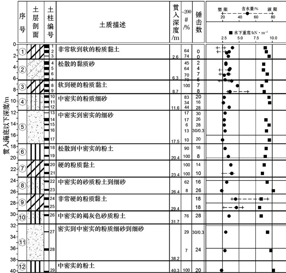
图2 钻孔柱状图和试验结果
