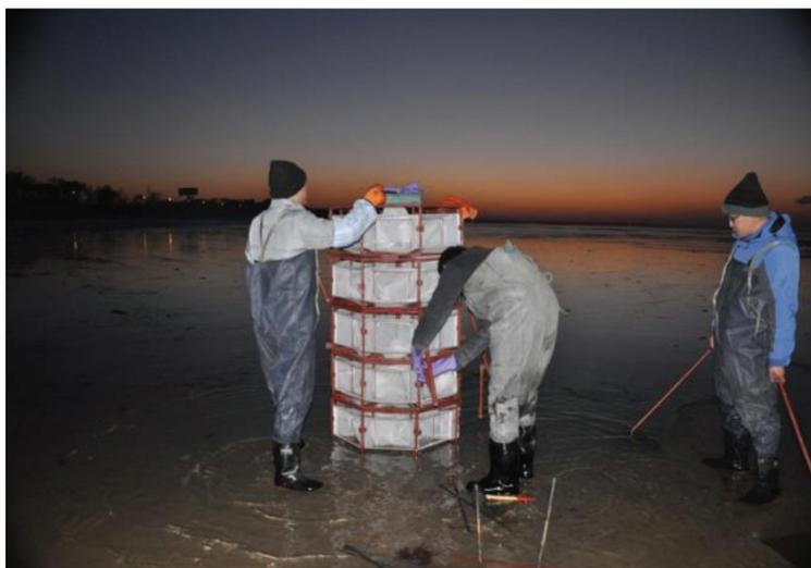
图 3 笼式泥沙捕获器投放
