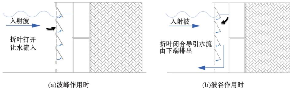
图 2 折叶板沉箱的消波构想图
