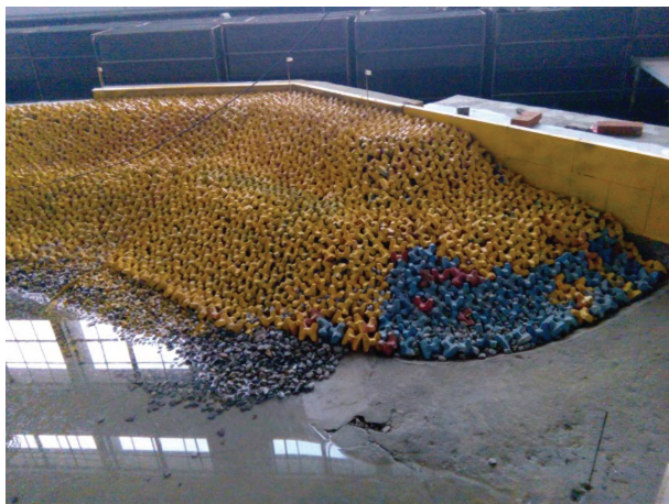
图 14 东护岸 C 段南端护面块体和护底块石稳定性情况
