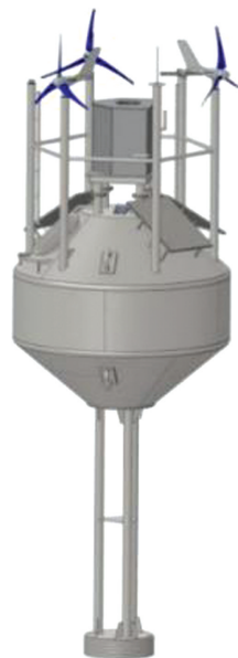
图 3 雷达测风装置示意图
