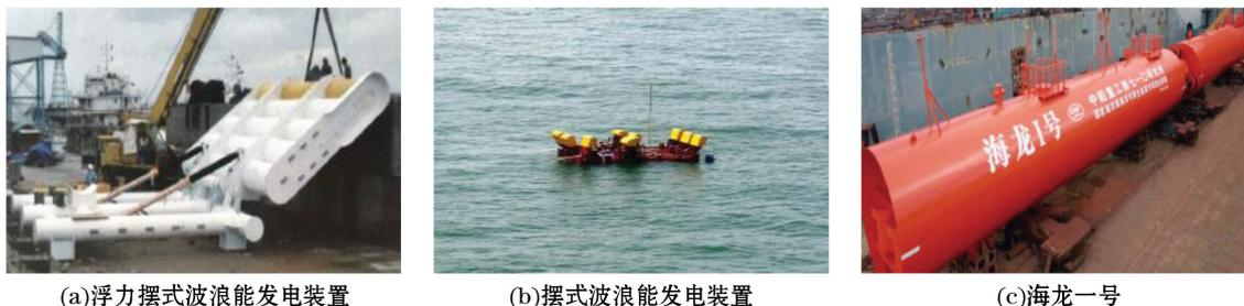
图 9 其他振荡体式波浪能发电装置
