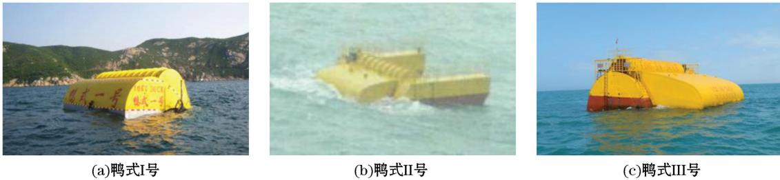
图 5 鸭式波浪能发电装置
